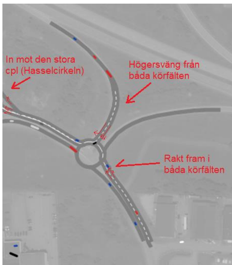
Figur 120: Skiss från VISSIM för cirkulationsplatsen med de södra ramperna. Körfältsindelningen som presenteras är viktig av kapacitetsskäl och för synkningen mot den stora cirkulationen.
