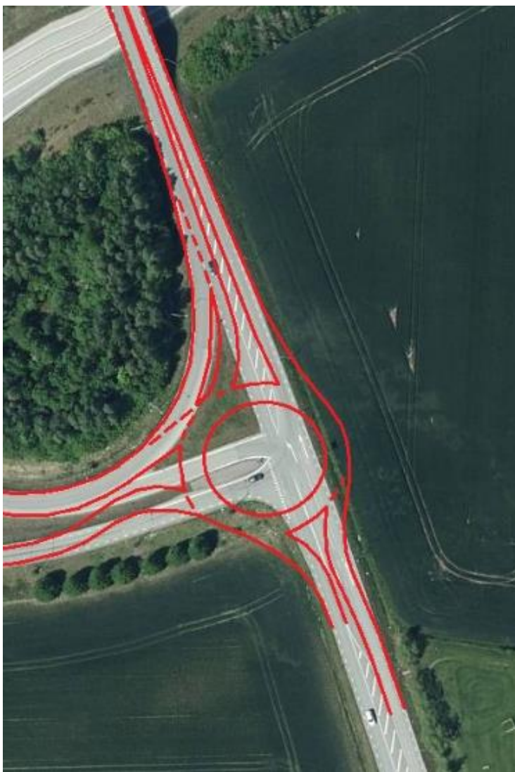
Figur 122: Enkel skiss över lämplig cirkulation. Den trafikanalys som har genomförts för prognosticerad trafik år 2050 visar att denna utformning med endast ett körfält in/genom/ut cirkulationen räcker. Dock skapas ett separat körfält från bron mot påfarten (som slutar med väjningsplikt), då detta körfält redan finns idag. Denna lösning ska ses som en helhet tillsammans med åtgärd E4. Se även det separata PM:et för trafikanalysen för Södra Staffanstorp (220419).
