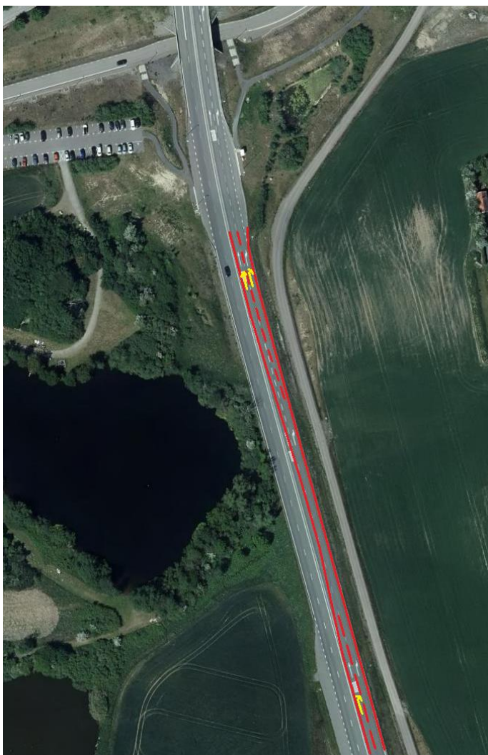
Figur 121: Principskiss där vänster fält upphör, huvudfältet leds successivt över till dagens K2, varpå högersvängsfältet successivt växer ut åt höger. Viktigt att det fortsatt blir en bra geometri för genomgående körfält, samt att högersvängsfältet har nått full bredd en bra bit före busshållplatsen. OBS! Även motsvarande utformning i södergående riktning norr om korsningen.
