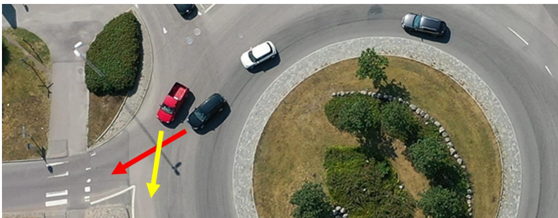
Figur 126: WSP:s drönarfilmning, exempel på konflikt i dagens utformning av flerfältig cirkulations-plats. Den svarta bilen måste panikbromsa till helt stillastående för den röda bilen.
