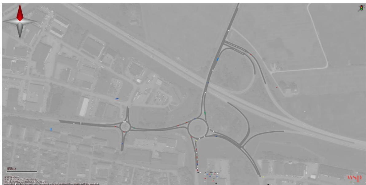
Figur 67: Ögonblicksbild från modellen, nuläge FM. Köbildning på väg 108 i norrgående riktning in mot cirkulationen (köns längd lär vara överskattad i modellen jämfört med verkligheten, även om kommunens representanter menar att en viss kö härifrån är realistisk). Eftersom trafiksituationen under morgonrusningen trots allt är mindre belastad än under eftermiddagsrusningen så görs ingen ytterligare kalibrering av detta scenario.
