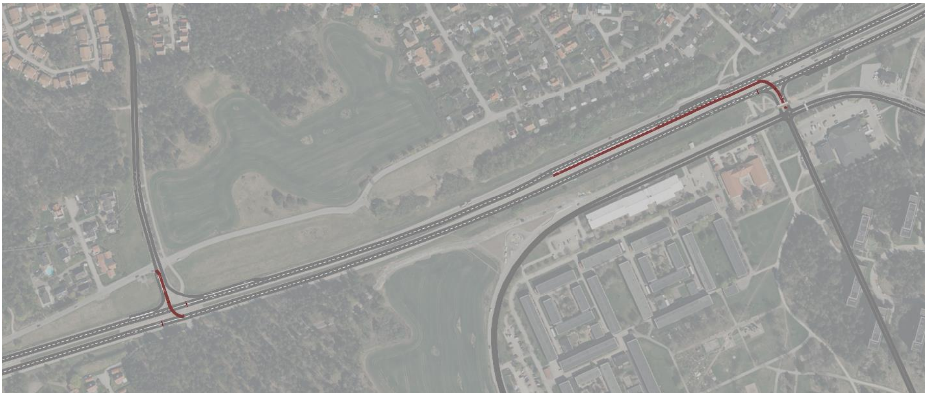
Figur 2. Principskiss över kollektivtrafiksignal från Stenhagsvägen och Flogstavägen, korsningarna stängs för vänstersväng för övrig trafik.
