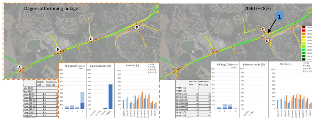
Figur 20. Medelhastigheter, kölängder och restider under eftermiddagens maxtimme för Alternativ utformning 1 på delsträcka 1. Intressanta områden är markerade med numrering och beskrivs i löptexten.
