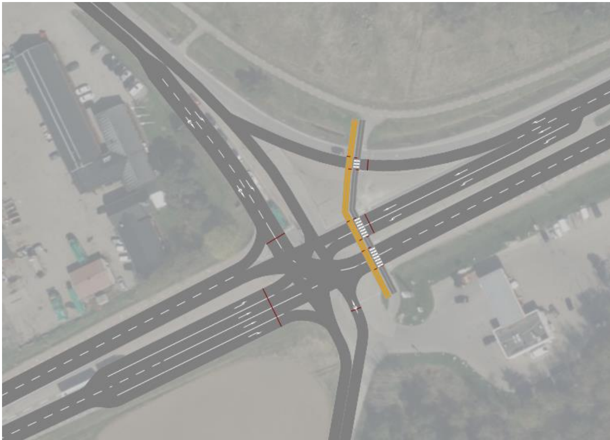
Figur 54. Typskiss över dubbla vänstersvängskörfält från väg 72 österut.
