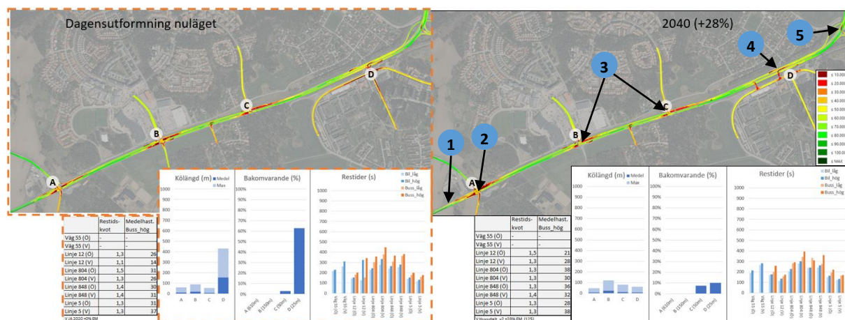
Figur 18. Medelhastigheter, köllängder och restider under eftermiddagens maxtimme för huvudalternativ 2 på delsträcka 1. Intressanta områden är markerade med numrering och beskrivs i löptexten.
