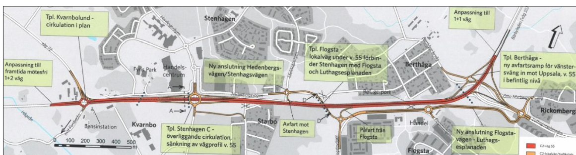
Figur 8. Systemlösning C2 – Som systemlösning C1, men med en halv trafikplats Flogsta som medger höger ut från Flogstavägen i riktning mot Uppsala och höger in mot Stenhagsvägen i riktning från Uppsala.
