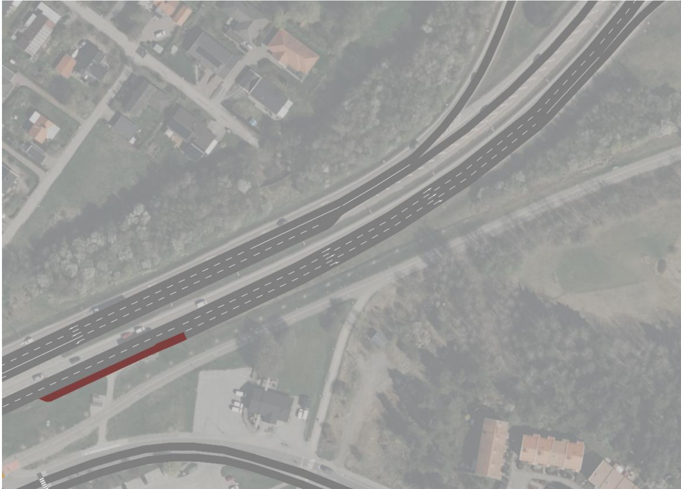
Figur 60. Typutförande av förlängt accelerationskörfält mot Luthagesplanaden från hållplats Flogsta C.
