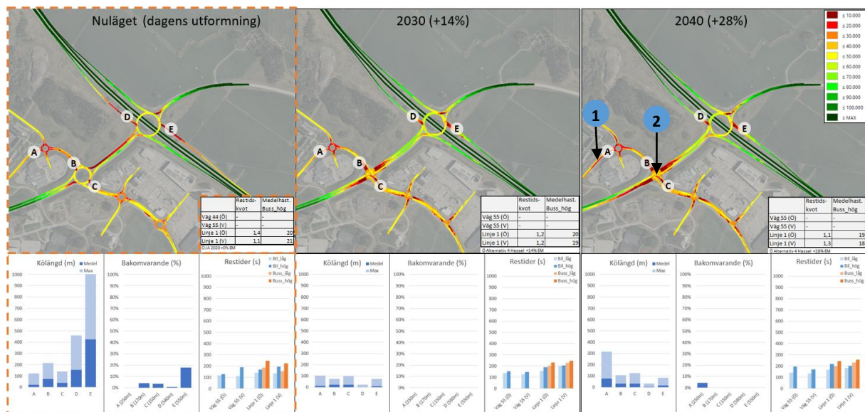
Figur 15. Medelhastigheter, kölängder och restider under eftermiddagens maxtimme för alternativ utformning 4 på delsträcka 3. Intressanta områden är markerade med numrering och beskrivs i löptexten.
