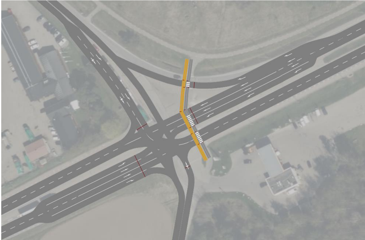
Figur 55. Typskiss över två körfält rakt fram och förlängt separat högersvängskörfält mot väg 72.
