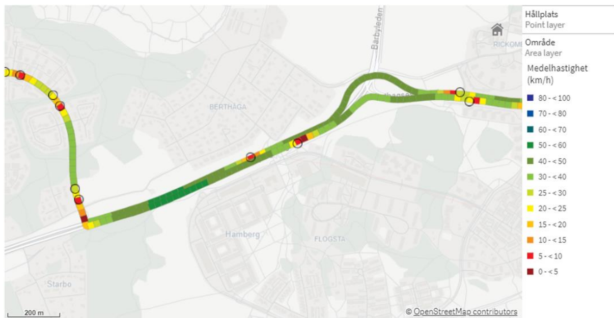
Figur 39. Medelhastigheter för busslinje 5 på väg 55 inom studieområdet, mellan trafikplats Berthåga i öst och Stenhagsvägen i väst. Ringarna i figuren markerar lägen för hållplatser.
