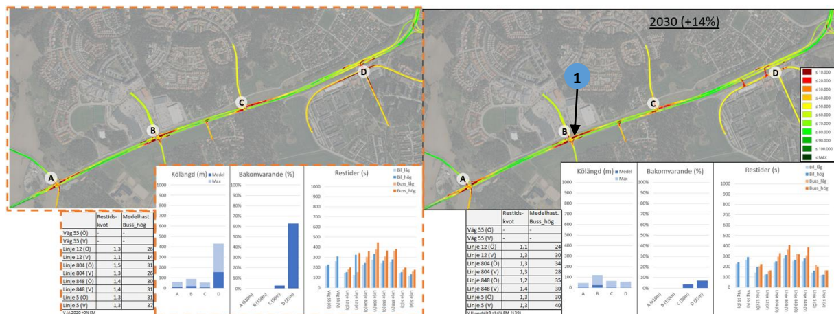
Figur 19. Medelhastigheter, körlängder och restider under eftermiddagens maxtimme för huvudalternativ 3 på delsträcka 1. Intressanta områden är markerade med numrering och beskrivs i löptexten.
