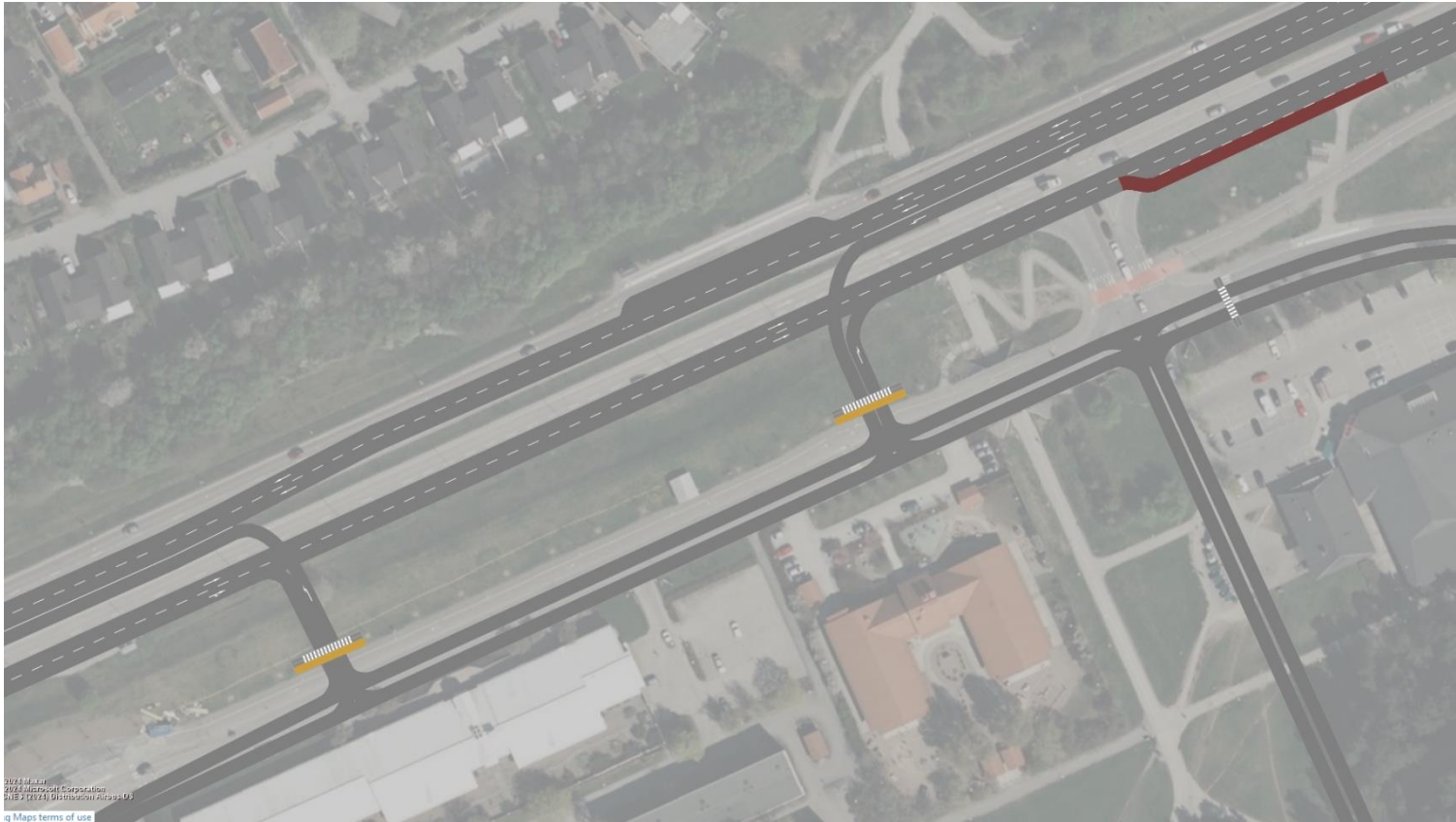
Figur 59. Typskiss över separata korsningar för vänstersväng in respektive ut från Flogstavägen.
