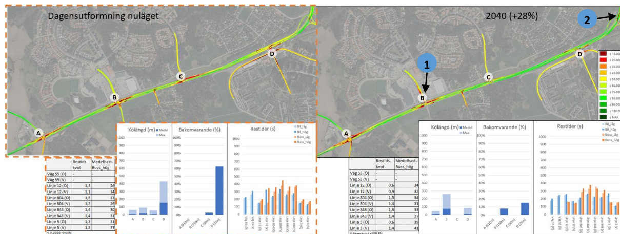
Figur 23. Medelhastigheter, kölängder och restider under eftermiddagens maxtimme för Alternativ utformning 4 på delsträcka 1. Intressanta områden är markerade med numrering och beskrivs i löptexten.
