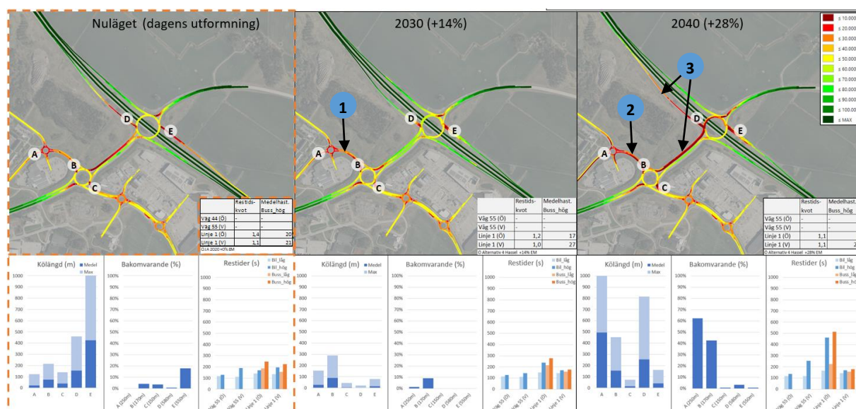
Figur 14. Medelhastigheter, körlängder och restider under eftermiddagens maxtimme för alternativ utformning 3 på delsträcka 3. Intressanta områden är markerade med numrering och beskrivs i löptexten.
