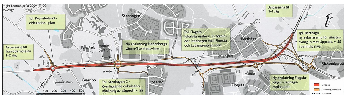
Figur 7. Systemlösning C1 – planskildhet vid Stenhagen C, men i övrigt mindre ombyggnader av befintliga trafikplatser. Till skillnad från systemlösning B1 och B2 har trafikplats Flogsta utgått.
