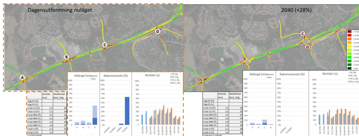
Figur 22. Medelhastigheter, kölängder och restider under eftermiddagens maxtimme för Alternativ utformning 3 på delsträcka 1. Intressanta områden är markerade med numrering och beskrivs i löptexten.
